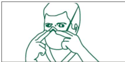
**⚠ Wenn Sie mit einer Hand auf die Nasenspitze drücken, kann dies zu einer fehlerhaften Versiegelung führen und die Schutzwirkung der Maske verringern. Verwenden Sie bitte mit beiden Händen**
