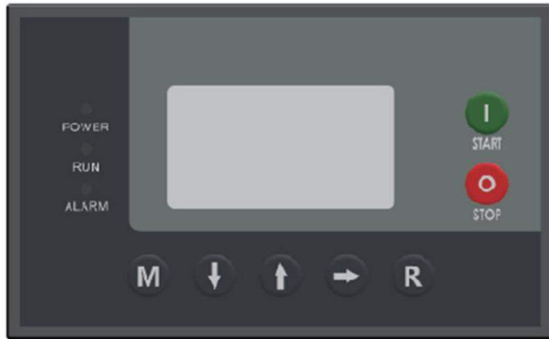
控制面板的控制采用1路温度1路压力的控制方式，数据处理作采用先进的控制方式，外设液晶显示屏与几个操作键实现人机界面。
