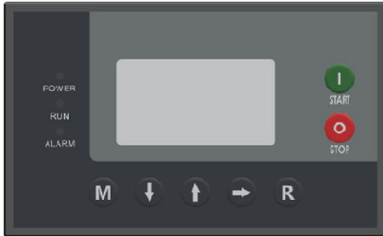
제어판의 제어는 1채널 온도 1채널 입력의 제어 방식을 사용하였고 데이터 처리는 선진적인 제어방식을 사용하였으며 액정 스크린과 몇개의 조작 버튼으로 HMI를 실현하였습니다.
