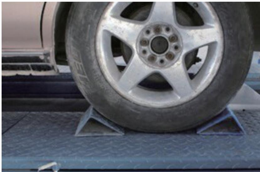
Este clipe é um dispositivo especial de quatro garras projetado para testes de posicionamento nas quatro rodas. Além da correção de alinhamento nas quatro rodas para modelos comuns, também pode ser usado para correção de alinhamento de quatro rodas de modelos de chassi ultraabaixos. Como mostrado na figura:
