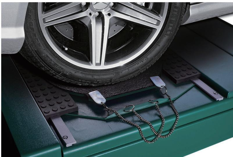
キングピン測定中に、車両が前後に動き、測定値に影響を与えないように、ラバーブロックで後輪を遮って、ターンテーブルピンを引き抜いて、ラバーパッドを取り外します。（ご参考までに）
