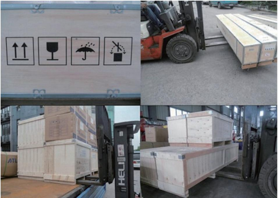
(Bemerkungen: Die maximale Tragfähigkeit des Gabelstaplers sollte größer als 0,5 Tonnen sein (nur für Referenz))
