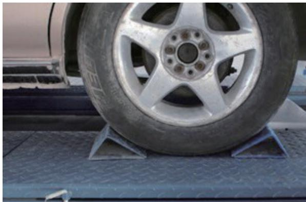
**2.3 Selección de la herramienta de sujeción****2.3.1 Introducción general de la herramienta de sujeción especial para la alineación de cuatro ruedas**
