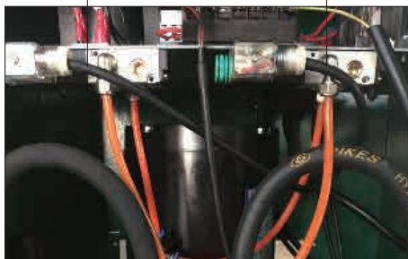
Figura 14 [método de conexão do cilindro de ar]
