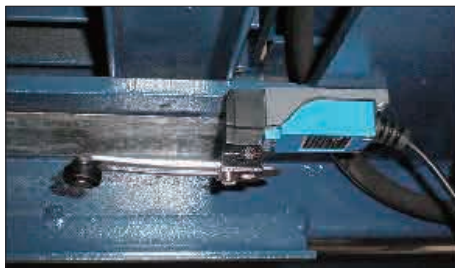
Figura 19 (comutador de limite de máquina principal)
