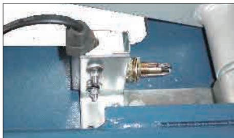
Рис. 18 (конечный выключатель вспомогательной машины)
