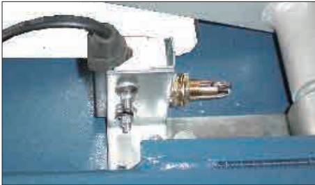
Figura 18 [Interruptor de límite de la unidad secundaria]
