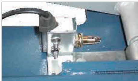
Figura 18 (interruptor de limite de sub-máquina)
