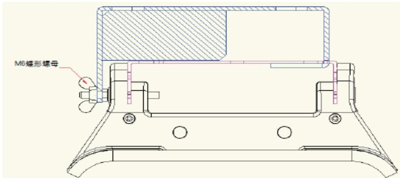
※ 注意：必ずスプリングワッシャーとウィングナットを締めてください。
