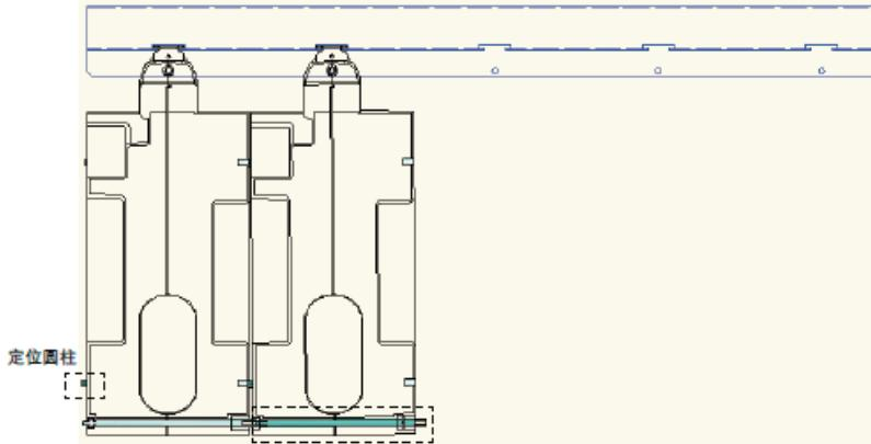
5) Nachdem alle Spuler nacheinander installiert sind, setzen Sie die M6-Federscheiben ein, die wie in der Abbildung gezeigt von dem Halterbolzen entfernt wurde, und ziehen Sie es mit der M6-Flügelmutter fest (Damit werden alle Spuler fixiert.).
