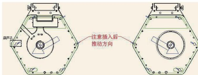
5.2 Таким образом, торцевые крышки соответственно устанавливаются на двух концах намоточного аппарата после сборки, установка и насадка намоточного аппарата завершаются.
