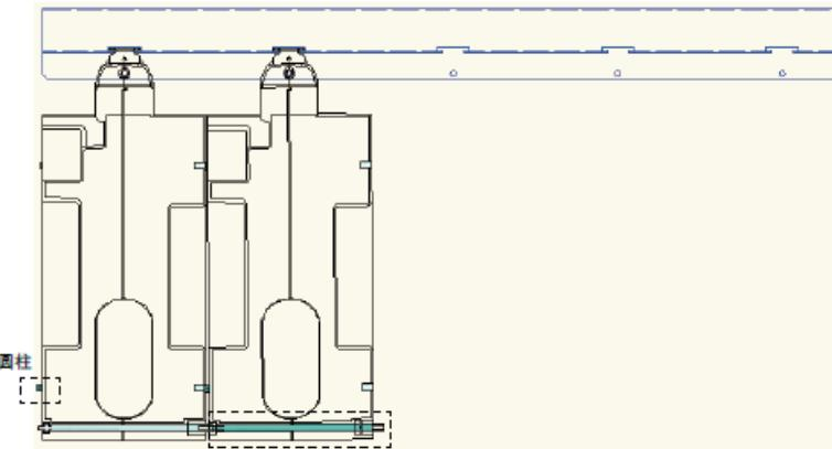
5) すべてのリールを取り付けたら、図のように外した M6 スプリングパッドをスタンドボルト取り付け、M6 バタフライナットで締めます（これによりすべてのリールが固定される）。
