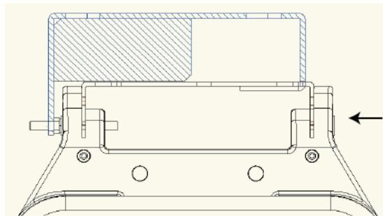
3) 打开端盖附件袋，取出 M8 螺母，将其嵌入卷线器的左侧六角孔内，并拧紧 M8 长螺栓。
