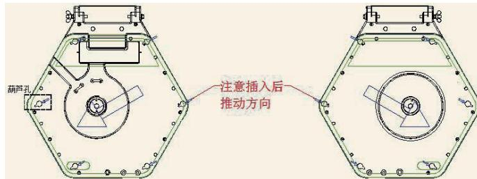
5.2 Auf diese Weise werden die Endkappen jeweils an den beiden Enden des kombinierten Spulers installiert und die Befestigung und das Zusammenwirken des Spulers ist abgeschlossen.
