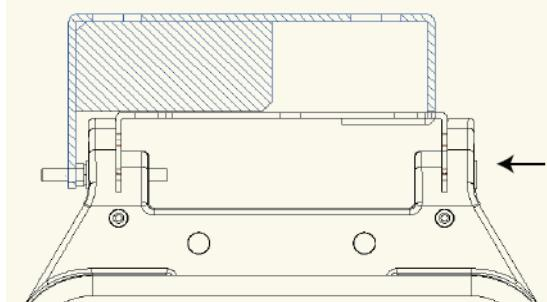
3) Abra la bolsa de accesorios de la tapa del extremo, saque la tuerca M8, insértela en el orificio hexagonal izquierdo del carrete de cable y apriete el perno largo M8.
