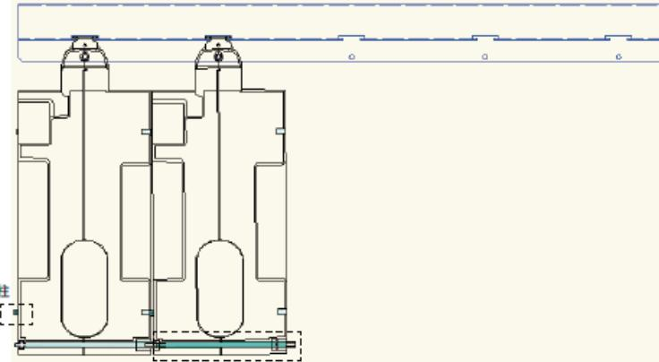
5) Después de que todos los carretes se instalen en secuencia, inserte la almohadilla de resorte M6 que se retiró del perno del soporte como se muestra en la figura y luego apriete con la tuerca de mariposa M6 (para que todos los carretes queden fijados).
