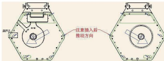
5.2 Deste modo, as tampas são instaladas respectivamente nas duas extremidades do carretel combinado, e a fixação e a cooperação do carretel serão completadas.
