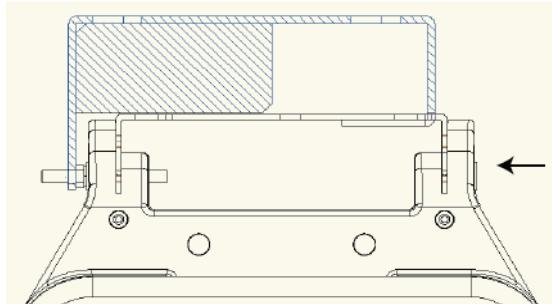
3) Abra a bolsa de acessórios da tampa de extremidade, retire a porca M8, insira-a no orifício hexagonal esquerdo do carretel e aperte o parafuso longo M8.
