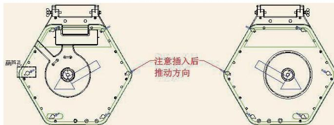
5.2 De esta manera, las tapas de extremo se instalan respectivamente en los dos extremos del carrete combinado, y se completa la fijación y la incorporación del carrete.
