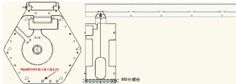
4) 次のリールを順にハンガービームに挿入し、ハウジングの左側から突き出している位置決めシリンダーを左側のリールの右側にある位置決め穴に合わせ、しっかりと手打ちして M8 ロングボルトを締めます。
