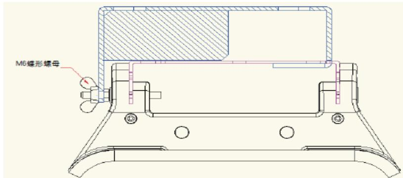
※ Внимание! Обязательно затянуть пружинные шайбы и барабашковые гайки.
