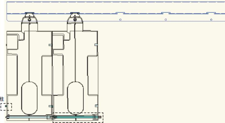
5) 전체 코일 권선기를 차례로 설치 완료한후 도면과 같이 브라켓 볼트 위에 시작시 분해한 M6 스프링 와셔를 장착한후 M6 나비모양 너트를 증체한다. (이렇게 전체 코일 권선기를 고정한다.)
