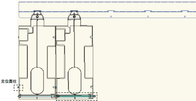
5) Depois que todos os carretéis forem instalados em ordem, instale a arruela elástica M6 que foi removida do parafuso de suporte como mostrado na figura e, em seguida, aperte com a porca de borboleta M6 (para que todos os carretéis sejam fixados).
