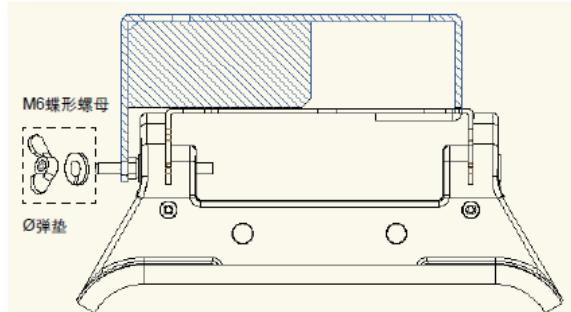
2) 根照工程要求的组合顺序，按从左到右的顺序，首先将最左侧卷线器支架如图插入吊架横梁内
