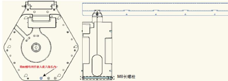
4) Inserte el carrete subsiguiente en la viga transversal de suspensión en orden, y alinee el cilindro de posicionamiento que sobresale del lado izquierdo de la caja con el orificio de posicionamiento en el lado derecho del carrete izquierdo. Presione firmemente y apriete el perno largo M8.
