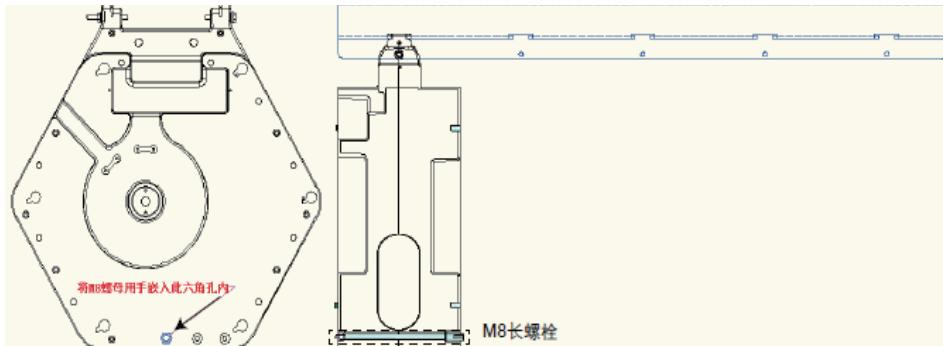
4) 按顺序将后续卷线器插入吊架横梁，并将壳体左侧凸出的定位圆柱对准左边卷线器右侧的定 位圆孔，拍击将其插紧，拧紧 M8 长螺栓。
