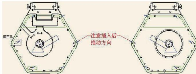
5.2 如此，组合后卷线器的两端分别安装好端盖，卷线器的固定与配合即完成。
