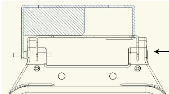
3) Öffnen Sie die Zubehörtascheder Endkappe und entfernen Sie die M8-Mutter, setzen Sie sie in das linke Sechskantloch des Spulers ein und ziehen Sie den langen M8-Bolzen fest.
