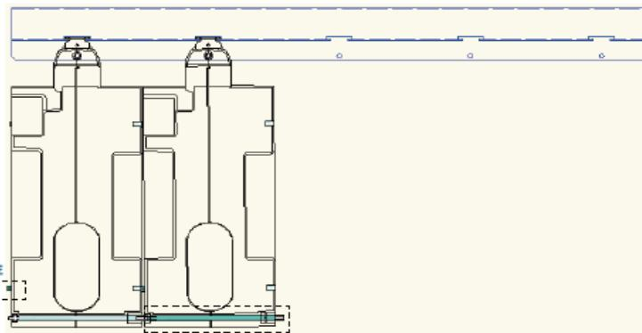
5) 将全部卷线器依次安装完成后，如图在支架螺栓上装入开始拆下的 M6 弹垫，然后用 M6 蝶 形螺母拧紧（如此固定全部卷线器）。
