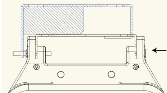
3) エンドキャップの付属品の袋を開き、M8 ナットを取り外し、リールの左の六角穴に挿入して、M8 ロングボルトを締めます。
