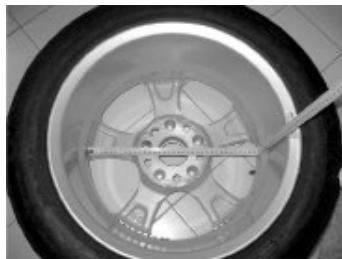
Abbildung F3.31 Manuelle Messung des Außendurchmessers (da2) im ALS1 / ALS2-Modus
