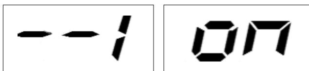
図 F3.13- アンバランスマップ位置の位置決め左側のウィンドウには、内側に正確なリード貼り付け位置を位置決めするために定規を引き出す（右に引く）方向が表示されます。
