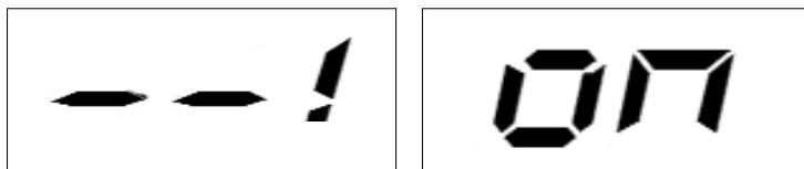
Рис.F3.13 – Определение положения точки дисбаланса: На левом окне отображается направление датчика, который толкается вправо, чтобы определить точное место крепления для балансировочного грузика на внутренней стороне колеса.
