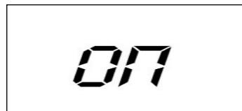
Рис. F8.0a - Включение высокого разрешения дисбаланса на дисплее
