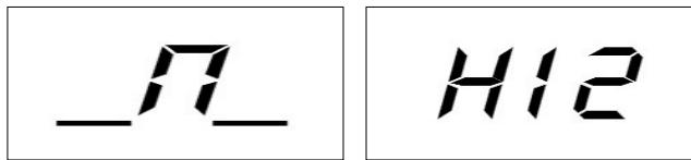
Figura F5.3 Mensaje "Ajuste la boquilla de rueda a la posición de las 12 en punto"
