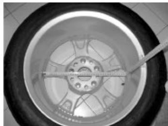
Figura F3.3.1 Medição manual do diâmetro externo (da2) no Modo ALS1 / ALS2
