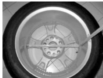
Figura F3.3.1 Demostración de medición manual del diámetro de lado exterior (da2) bajo el modo ALS1 / ALS2
