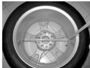
Рис. F3.3.1 - Пример ручного измерения внешнего диаметра ( $da_2$ ) колеса в программах ALS1/ALS2
