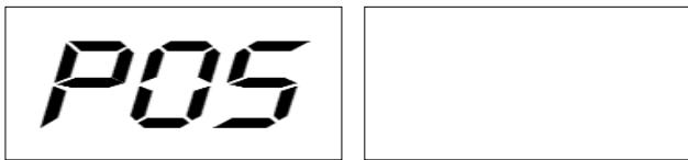
図 F3.15- アンバランスマップ位置の位置決め左側のウィンドウは、定規が正確な位置に位置決めされていることを示しています
