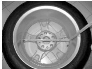
図 F3.31 ALS1 / ALS2 モードでの外径 ( $da_2$ ) の手動測定の例
