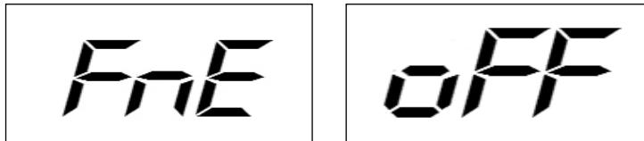
Рис. F8.0b - Отключение высокого разрешения дисбаланса на дисплее
