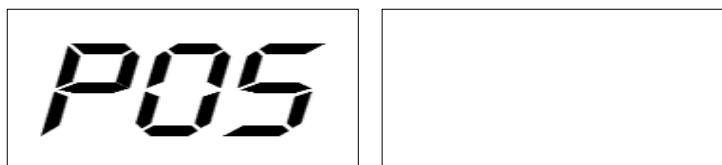
그림 F3.15- 언밸런스 포인트 위치 확정 좌측 창구에 줄자가 이미 정확한 곳에 위치했음을 표시한다.
