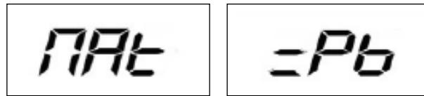
図 F9.2 鉛として材料を選択する
