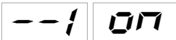
图 F3.13- 不平衡点位置定位：左侧窗口显示的拉尺拉动方向（向右拉动）以便定位到内侧的精确贴铅位。
