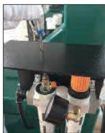
Überprüfen Sie den Schmierzustand täglich, um sicherzustellen, dass der Schmierstoff beim Drücken des Fußes in den Schmierstoffgeber tropft. Verwenden Sie einen Schraubendreher, um die Einstellschraube des Ölerstreuers bei Bedarf einzustellen.
