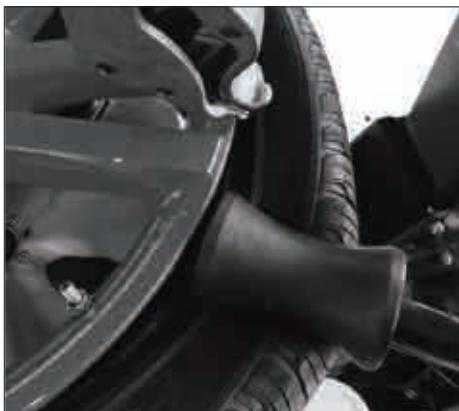
3.1 Pressione o rolo de pressão do pneu com o braço auxiliar e pressione o pneu como mostrado na figura
