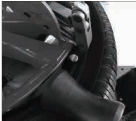
3.3 Ziehen Sie das manuelle Steuerventil des Demontagekopfs nach unten und stecken Sie den Reifenabnahmehaken in den Reifen.
