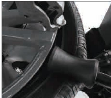
3.2 下へ六角レバーを回して手動制御弁を昇降させます。タイヤ脱着ヘッドがリム上方より 2 mmです。
