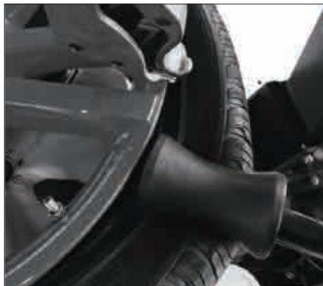
3.2 向下扳动六角杆升降手控阀，拆装头距离轮辋上方2mm
