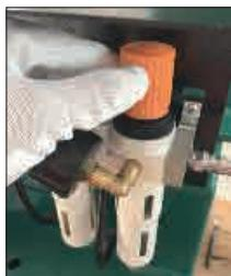
Saque la cubierta y gire para ajustar la presión, el rango de ajuste de presión es 8-10Bar.
