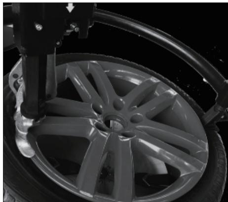
3.5 Primero presione el neumático con el brazo de flexión auxiliar. Luego levante la válvula de control manual del cabezal de desmontaje y montaje, y levante el neumático con el gancho de desmontaje.
