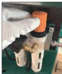
Ziehen Sie die Abdeckung heraus und drehen Sie sie, um den Druck einzustellen. Der Druckeinstellbereich beträgt 8-10Bar.
