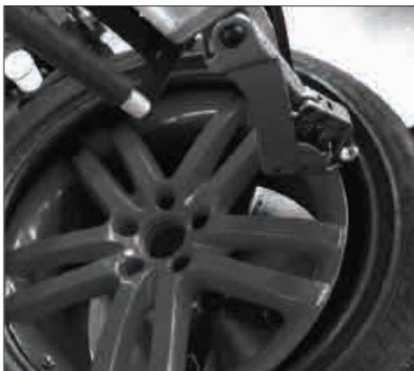
3.10 リムはテーブルと共に時計回りに回転します。タイヤの下方から先に組付けます。
