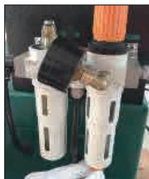
Verifique a altura do nível de água no separador de vapor-água, não exceda 50% da altura do separador. Se necessário, gire o botão de trava para drenar manualmente.
