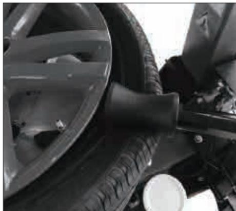
3.1 Нажать ролик шины вспомогательной стрелой, по схеме нажать шину.
