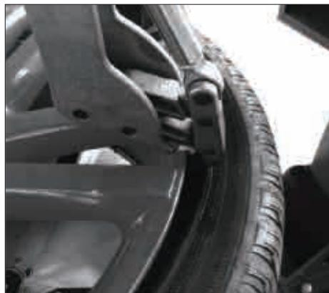
3.4 フックがタイヤ内部までに挿入するまでに手動制御弁を押します。
