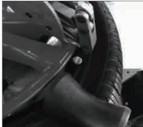
3.3 Tire hacia abajo la válvula de control manual del cabezal de desmontaje y montaje, e inserte el gancho de desmontaje en el neumático.
