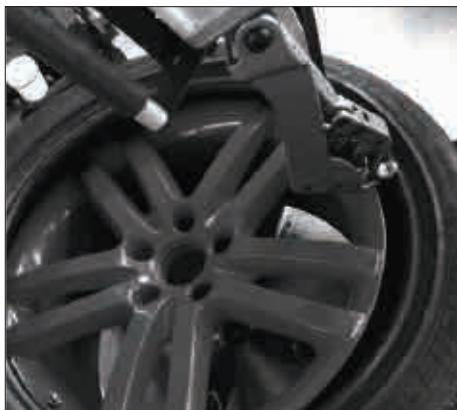
3.10 Повернуть приводящий патроном в движение обод по часовой стрелке и сначала загрузить нижний слой шины.
