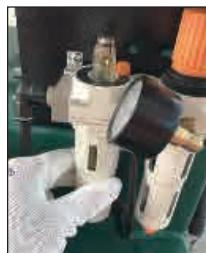
Verifique o nível do óleo lubrificante todos os dias e abra a tampa de óleo para reabastecer o óleo, se necessário. Observe que é proibido usar óleo lubrificante que tenha sido exposto ao ar por um longo período.
