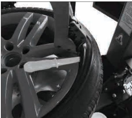
3.6 Вставить пластмассовый лом, нажать поворотную педаль, чтобы зажимной патрон приводил шину к вращению по часовой стрелке, односторонняя шина разделилась.
