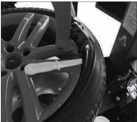
3.6 插入塑料撬棍，踏下旋转脚踏，使卡盘带动轮胎顺时针旋转，单面轮胎分离
