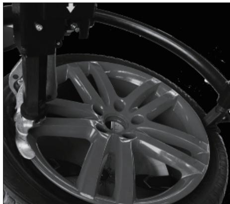
3.5 先用辅助弯臂下压轮胎 . 然后向上扳动拆装头手控阀，拆胎钩将轮胎勾起
