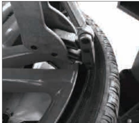
3.4 Drücken Sie das Handventil, bis sich der Reifenhaken tief im Reifen befindet
