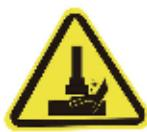
Nunca coloque qualquer parte do seu corpo sob a cabeça de troca
