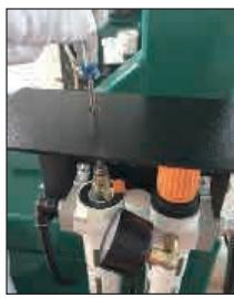
毎日グリースをチェックして、ペダルを踏むとグリースがオイルミスターに垂れることを確認します。必要な場合にはドライバーでオイルミスターの調節ねじを調整します。
