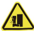
Al presionar el neumático, no se pare entre la paleta y el neumático para evitar lesiones.
