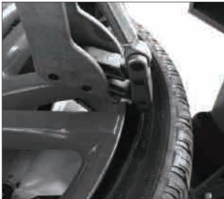
3.3 Puxe a válvula de controle manual da cabeça de troca para baixo e insira o gancho de troca de pneus no pneu
