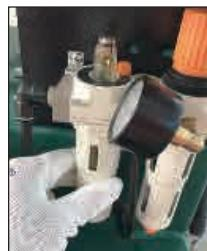
Überprüfen Sie täglich den Ölstand und öffnen Sie bei Bedarf den Öldeckel zur Nachfüllung. Beachten Sie, dass es verboten ist, Schmiermittel zu verwenden, die lange Zeit der Luft ausgesetzt waren.
