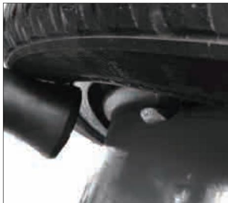
3.7 Usando o rolete de pneus do braço auxiliar, levante o pneu, puxe a válvula de controle manual da cabeça de troca para baixo e estenda o gancho para prender a boca do pneu sob o pneu
