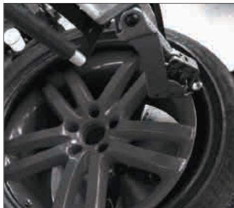
3.10 Drehen Sie die Felge des Spannfutters im Uhrzeigersinn und laden Sie zuerst die untere Reifenlage.
