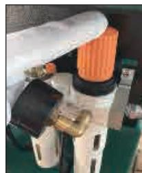
Drücken Sie die Abdeckung nach unten, um den Druck zu verriegeln.
