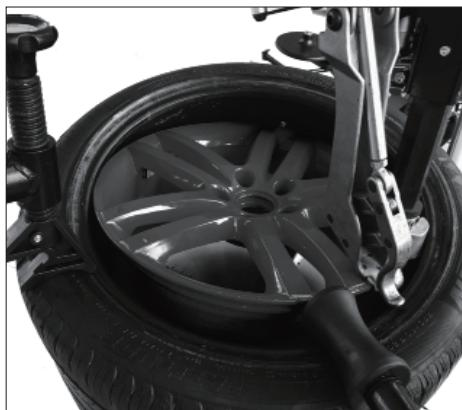
3.11 Как показано на рис., нажать валок для прессования покрышки и блок для прессования покрышки ниже края обода, лучше не снимать шины, загрузить верхний слой.
