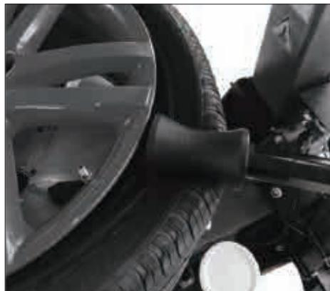
3.1 用辅助臂压胎辊，按图示将轮胎压下
