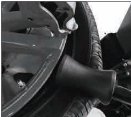
3.2 Tire hacia abajo la válvula de control manual de elevación de la barra hexagonal, el cabezal de desmontaje y montaje está a 2mm por encima del calce.
