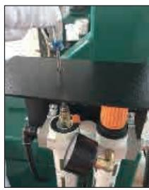
Verifique a condição de lubrificação diariamente para garantir que o lubrificante caia no lubrificador de névoa quando o pedal for pisado. Caso necessário, use uma chave de fenda para ajustar o parafuso de ajuste do lubrificador de névoa.
