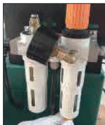
Überprüfen Sie regelmäßig den Wasserstand des Dampfabscheiders. Überschreiten Sie nicht 50% des Abscheiders. Drehen Sie gegebenenfalls den Verriegelungsknopf, um den Dampf manuell abzulassen.
