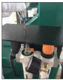
Каждый день проверить состояние смазки, обеспечить, что при нажатии ногой на педаль смазочное масло каплет в маслораспылитель. При необходимости можно регулировать регулировочный винт маслораспылителя с помощью отвертки.
