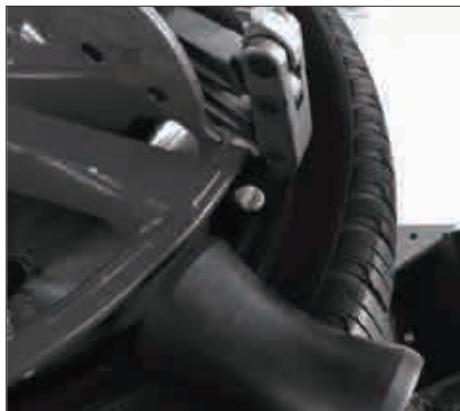
3.3 Повернуть вниз ручной клапан управления головкой для разборки и сборки, чтобы выдвинуть крюк для снятия и вставить его в шину.
