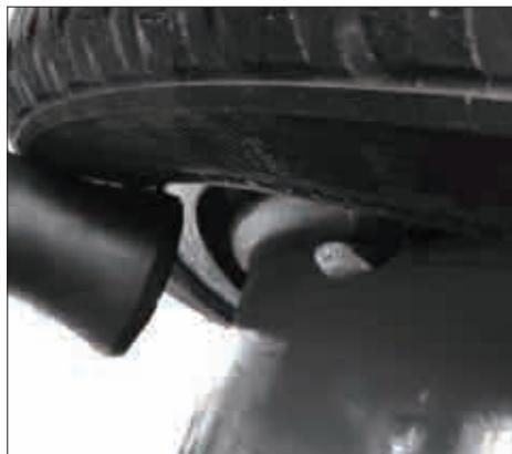
3.7 使用辅助臂托胎滚轮，将轮胎托起，向下扳动拆装头手控阀，将拆胎钩伸出钩住轮胎下胎口
