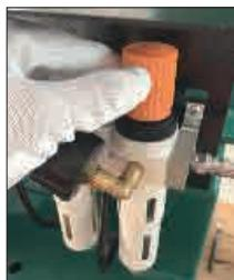
Вытащить крышку, вращать и регулировать давление, установленный диапазон давления: 8-10 бар
