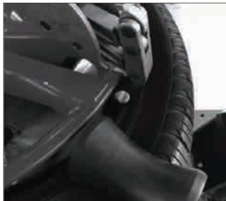
3.3 タイヤ脱着ヘッド手動制御弁を下へねじ回すと、タイヤ脱着ヘッドのフックがタイヤに挿します。
