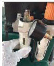
毎日グリースの液面をチェックします。必要な場合にはキャップを開けて給脂します。ご注意: 長時間に空気に暴露したグリースを使用することが禁止です。
