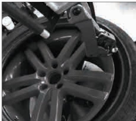
3.10 Gire en sentido de las agujas del reloj el calce empujado por el disco de sujeción, así se monta primero la parte inferior del neumático.
