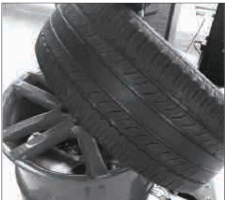
3.8 踏下旋转脚踏，使卡盘带动轮胎顺时针旋转，此时轮胎下胎口脱离轮毂
