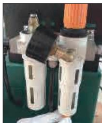
Периодически проверять высоту уровня воды в пароводяном сепараторе, нельзя превышать 50% высоты сепаратора, при необходимости можно вращать стопорную кнопку для искусственной канализации.
