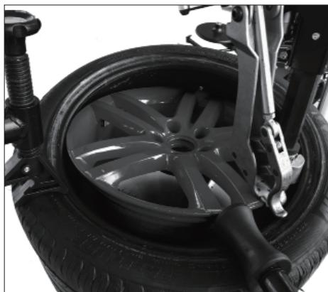
3.11 Como se muestra en la figura, coloque la palanca de prensa y el bloque de prensa debajo del borde del calce, para que el neumático no salga, y monte la parte superior.
