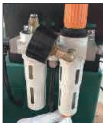
Compruebe regularmente la altura del nivel de agua del separador de vapor - agua. No exceda el 50% de la altura del separador. Y en caso necesario, gire el botón de bloqueo para drenar manualmente.
