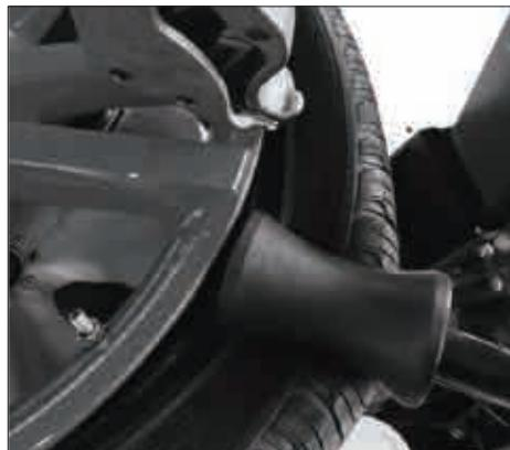
3.2 Drücken Sie den Sechskanthebel nach unten und ziehen am Steuerventil nach oben. Der Demontagekopf befindet sich 2 mm über der Felge
