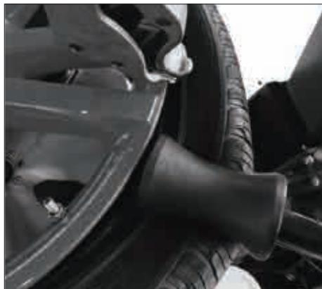
3.2 Повернуть подъемно-спускной ручной клапан шестигранной штанги вниз, расстояние между головкой для разборки и сборки и верхней частью обода составляет 2 мм.
