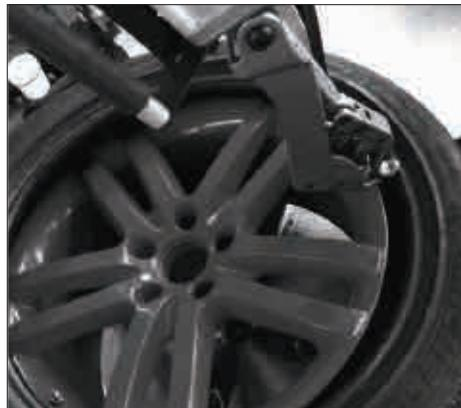
3.10 顺时针旋转卡盘带动的轮辋，轮胎下层先装入
