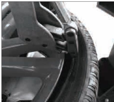
3.4 Нажать ручной клапан управления до тех пор, пока крюк для снятия шины не вставлен в шину.
