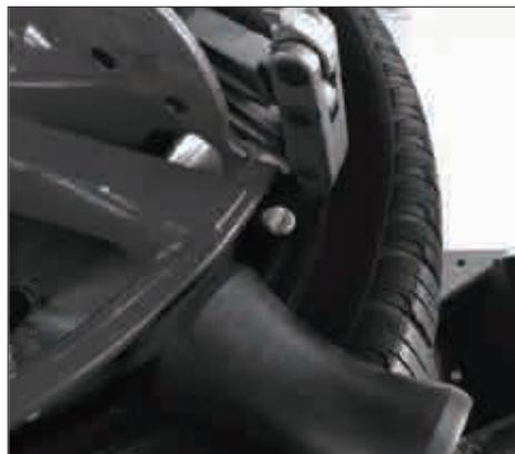
3.3 向下扳动拆装头手控阀，将拆胎钩伸出插入轮胎
