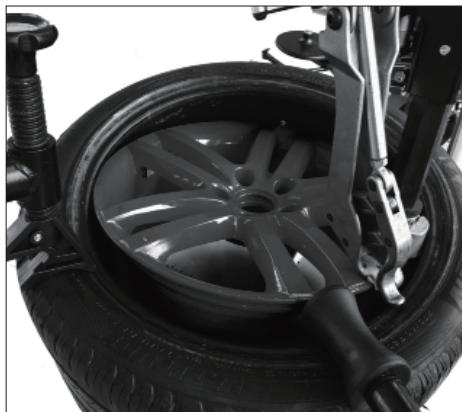
3.11 Pressione o rolo de pressão e o bloco de pressão de pneus abaixo da borda do aro conforme mostrado na figura, para que o pneu não saia e monte a camada superior
