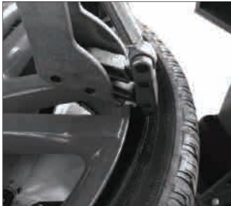
3.4 Presione la válvula de control manual hasta que el gancho de desmontaje esté dentro del neumático.
