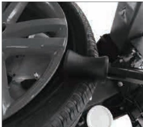
3.1 Drücken Sie die Reifenrolle mit dem Hilfsarm und drücken Sie den Reifen wie abgebildet
