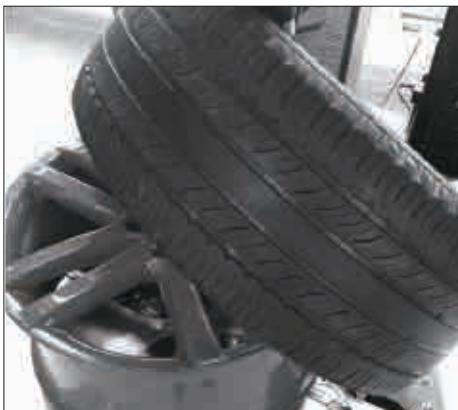
3.8 Нажать ногой вниз на поворотный педаль, чтобы зажимной патрон приводил шину в движение по часовой стрелке, при этом нижняя кромка шины отделена от ступицы.
