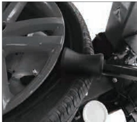
3.1 Presione el neumático como se muestra en la figura con el rollo de presión de neumático del brazo auxiliar de prensa.
