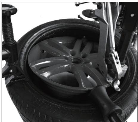
3.11 図のように、タイヤ固定ローラ及びタイヤ固定ブラックをリムの縁以下に固定してタイヤの脱落を防ぎます。タイヤの上方を組付けます。
