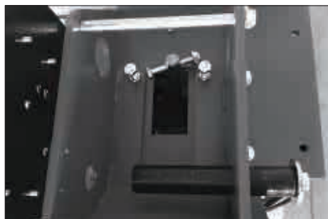
а. Снять вал стойки на заднем наклонном плече для установки
