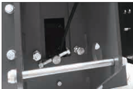
б. Переходить газовую трубу на стойке через квадратный паз на заднем наклонном плече
