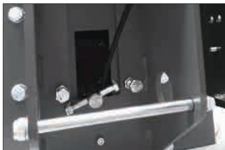
b. 将立柱上的气管穿过后倾斜臂座上的方槽中
