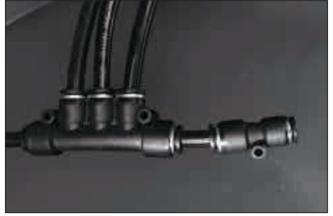
d. 기동의 에어 파이프를 8-6 조인트에 연결하고 사이드 플레이트를 다시 장착하십시오
