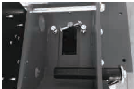
a. 後倒れアームシャーシのタワー回転軸を取り外す
