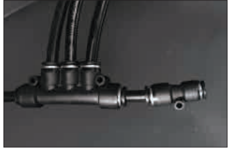
d. タワーの空気管を「切替 (8-6)」ジョイントと接続させてもう一度サイドプレートを設置する
