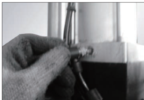
Figura 7-7 Instale el codo unido al tubo al cilindro, como se muestra en la Figura 7-7.
