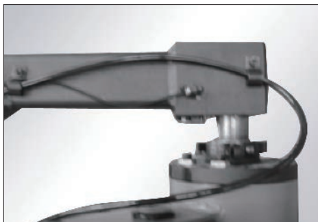
图 7-6 轻微摆动辅助臂主体, 直到辅助臂主体下到最低端, 如图 7-6
