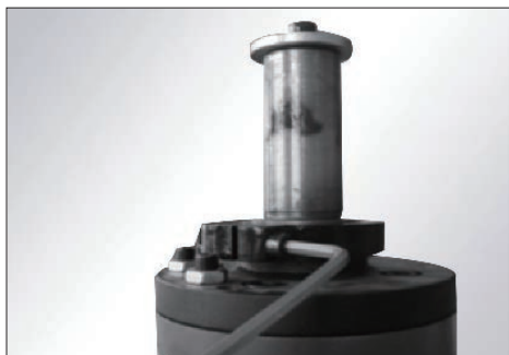
图 7-3 用 6# 内六角扳手紧固中心定位卡圈的螺丝, 如图 7-3
