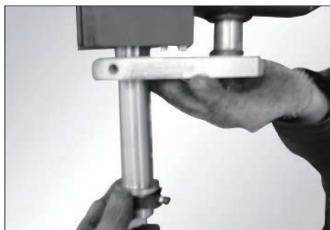
图 7-9 拆掉辅助臂旋转臂固定轴，如图 7-9；
