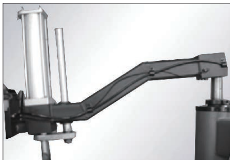
图 7-5 把辅助臂主体 (汽缸体向上) 安装到立柱上面的转轴, 如图 7-5;
