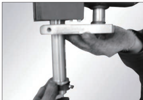
Figura 7-9 Retire el eje de fijación del brazo giratorio del brazo auxiliar, como se muestra en la Figura 7-9;
