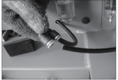
图 7-14 将辅助臂上的 PU 管与油水分离器下面的三通连接，如图 7-14。
