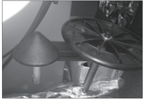
图 7-15 对安装好的辅助臂进行对调试，如图 7-15 中的 1 是调整仰角的，图中 2 是调整左右和锁紧间距的，将附件靠胎盘和定心杆子放置在箱体后的支架上方便使用，如图 7-16
