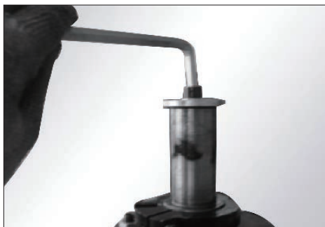
图 7-4 用 10# 内六角扳手拆掉辅助臂固定螺丝, 如图 7-4
