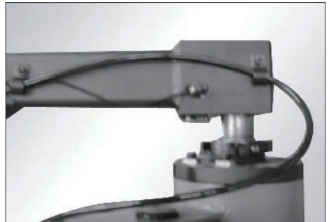
도면 7-5 도면 7-5 와 같이 보조 암 본체를 [ 실린더는 위로 향한다. ] 칼럼 위의 회전축에 설치하고 도면 7-6 과 같이 보조암 본체가 최저점까지 내려갈 때까지 보조 암 본체를 미세하게 움직인다.
