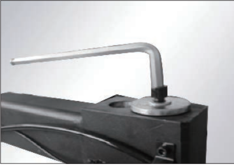
图 7-13 用 10# 内六角扳手紧固辅助臂上面的螺丝，如图 7-13；
