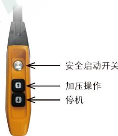
5. 重复操作步骤 4 的“上”键数次直到扳手上的套筒不再转动即表示已到达锁紧状态，即可放开“上”键然后按下“下”键，使液压泵回到归零状态。
