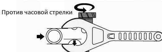
4. Безопасно надеть трубу на вал переката, поворачивать кнопку подачи до тех пор, пока лезвие не касается трубы и зафиксирует трубу. При этом нужно обратить внимание на то, что не надо повернуть кнопку подачи до упора.
