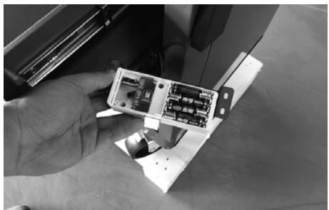
第五步：安装锁盒，调节锁盒位置，安装螺丝到螺丝孔最右端
