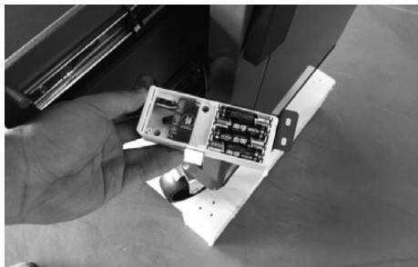
Paso 5: Instale la caja del bloqueo, regule la posición de la caja del bloqueo, instale el tornillo en el lado más derecho del agujero del tornillo
