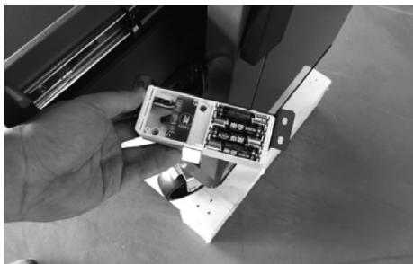
Пятый шаг: установить коробку для замка, регулировать положение коробки для замка, установить винт до правого края отверстия винта.
