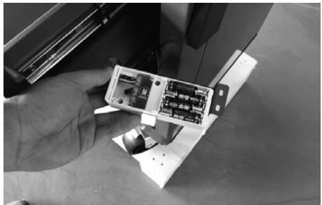
Schritt 5: Die Schließbox installieren, die Position des Schließkastens einstellen und die Schraube am rechten Ende des Schraublaufs installieren.
