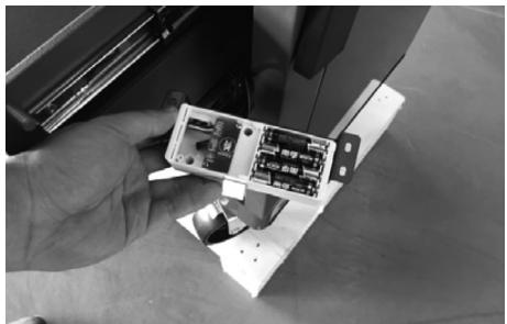
Etapa 5: instala-se a caixa de fechadura, ajusta-se a sua localização e instalam-se os parafusos no extremo a direito dos buracos
