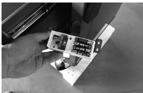
第五步：ロックボックスを取り付け、ロックボックス位置を調節し、ネジをネジ穴の最右端に取り付けます
