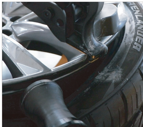
3.6 向下扳动六角杆升降手控阀，拆装头距离轮辋上方2mm
