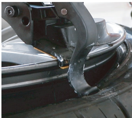
3.7 向下扳动拆装头手控阀，将拆胎钩伸出插入轮胎
