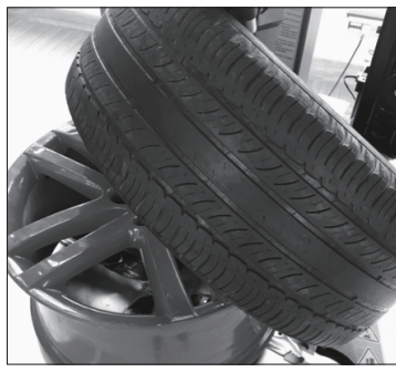
3.12 踏下旋转脚踏，使卡盘带动轮胎顺时针旋转，此时轮胎下胎口脱离轮毂
