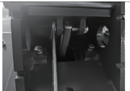
f. 将气缸杆用螺栓与立柱连接
