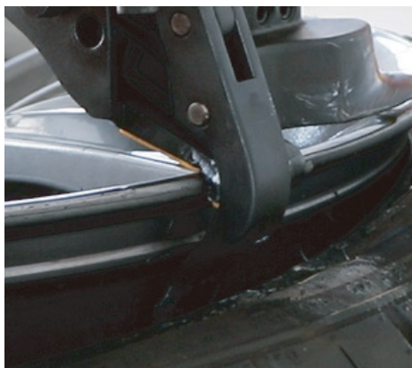
3.8 按下手控阀直至拆胎钩深入轮胎内部
