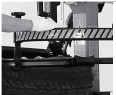
3.9 先用辅助弯臂下压轮胎，然后向上扳动拆装头手控阀，拆胎钩将轮胎勾起
