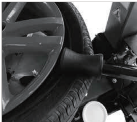
3.5 用辅助臂压胎辊，按图示将轮胎压下
