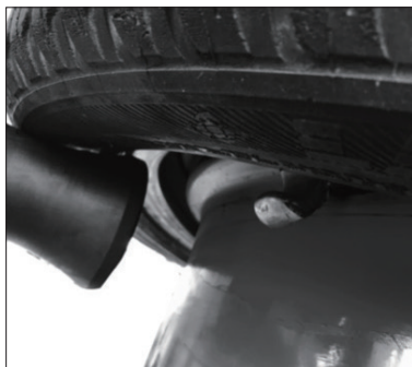
3.11 使用辅助臂托胎滚轮，将轮胎托起，向下扳动拆装头手控阀，将拆胎钩伸出钩住轮胎下胎口
