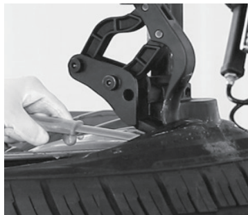
3.10 插入塑料撬棍，踏下旋转脚踏，使卡盘带动轮胎顺时针旋转，单面轮胎分离
