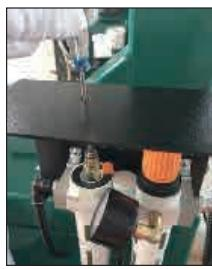
每天检查润滑状况，确保踩压踏脚时润滑油滴入油雾器中。需要时可使用螺丝刀调整油雾器调节螺丝。
