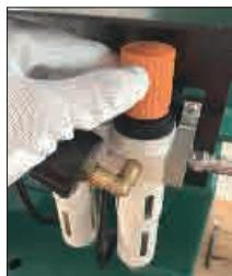
拔出盖子，旋转可调节压力，压力设定范围为8-10Bar
