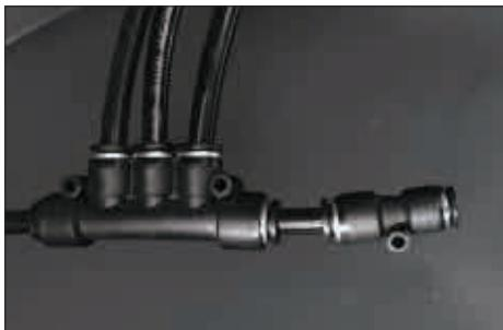
d. 将立柱上的气管与“8转6”接头相连，重新安装侧板
