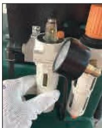
每天检查润滑油液位，需要时可打开油盖添加。注意，禁止使用长期暴露于空气中的润滑油。
