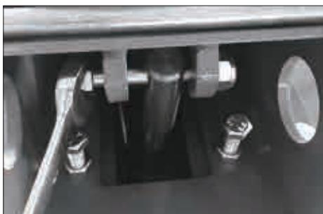
f. 将气缸杆用螺栓与立柱连接
