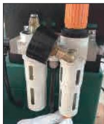
定时检查汽水分离器水位高度，请勿超过分离器50%高度，必要时可转动锁紧钮，人工排水。
