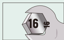
扳手尺寸与螺帽型号必须相同
