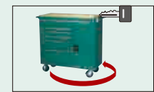
移动工具箱前确保柜箱上锁, 并处于滑轮活动状态
