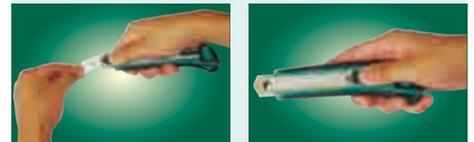
① 将推钮推至顶端, 取下刀片
