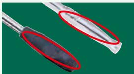
在棘轮扳手手柄上有明显的凹痕或电镀脱落，显示此柄曾被不正常的用锤头敲击或加长手柄(套长管)使用。
