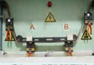
通过10000V极限绝缘耐压测试
