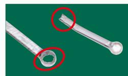
两用扳手弯曲变形或破裂，显示此扳手曾被敲击或当撬杆使用。
