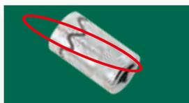
套筒头方孔处有明显的破损打滑，或筒壁有明显的裂痕，表示曾使用在风动工具上。
