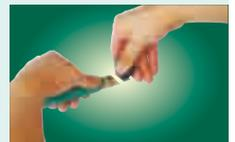
④ 拔下后盖, 将刀片插进后盖凹槽内, 沿折痕折断(注意事项: 每次限折断一节, 以防刀片飞崩)
