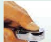
每只锁定接杆均有锁定/快速脱落按钮。只需按住锁定/快速脱落按钮, 都可锁住套筒头, 每只接杆相互锁定, 以保证锁定最终套筒头, 只有再按一次该按钮, 才可松开套筒头
